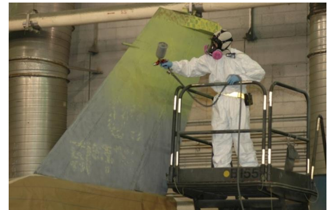
Barrier coat encapsulates chrome primer Chrome primer application on F-16
