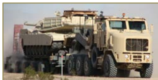
HET M1070 Transport, Recover, and Evacuate a 70 ton MBT
