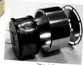
이용한 관상력 발전장치 소형화 설계 Generators Using Ring-Shaped Magnet of Small-Caliber Electronic Fuze 윤석현* on, Sang-Hyeon
